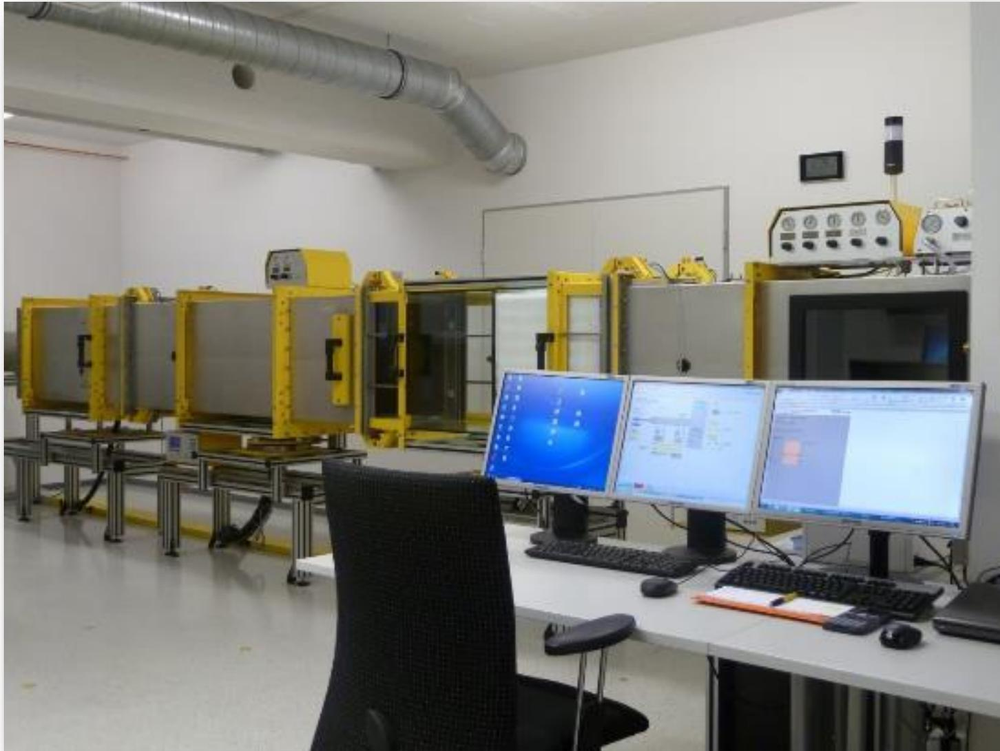
Banco de ensayo para la medición de filtros Coarse y ePM
