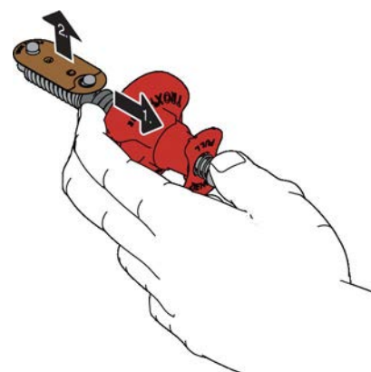
Fig. 131: Substituir o fusível térmico
