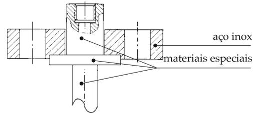
Fabricado com flange em aço inox e as partes molhadas em materiais especiais.
