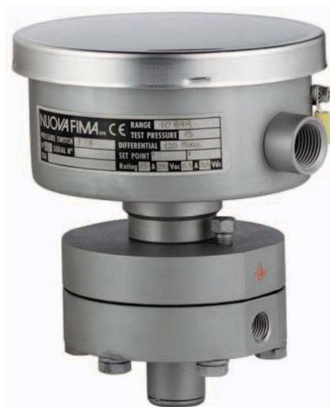
Construídos com execução estanque IP 65, são adaptados para serem utilizados nas indústrias alimentares, conservantes, farmacêuticas, petroquímica, centrais convencionais e nucleares, onde é necessário o controle de pressão diferencial e de nível. O elemento sensível é construído de uma membrana com duplo fole que por meio de um eixo soldado autocentrante vai intervir diretamente sobre o microinterruptor.
