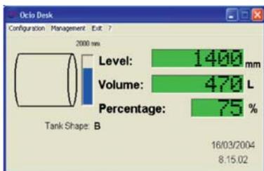
Uma máscara permite visualizar no monitor do PC os dados relativos ao nível, volume, % do volume contido no depósito.
