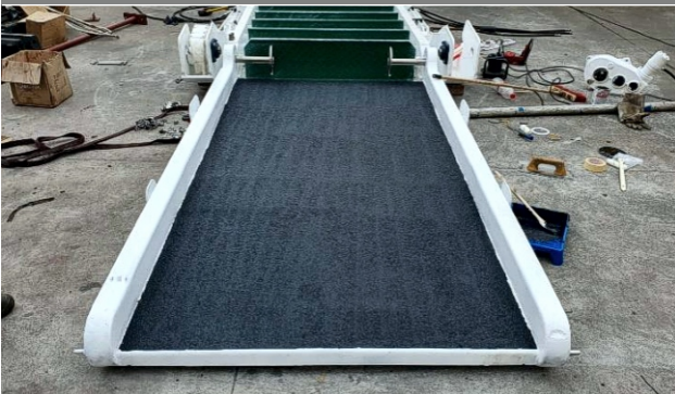
Rampa de Acesso Pedonal ao Barco LOCTITE PC 6315 & 6261
