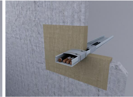
Esteira de cabos com FW2 firestop wrap (125 mm fora)
