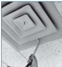
TUBO DE PITOT Pormenor de medição (difusor ou grelha)
