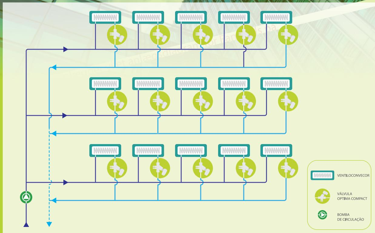
Se as válvulas forem equipadas com a nova série de atuadores «LOGICA DIGITAL» estas podem ser controladas e monitorizadas diretamente via bus de comunicações – com protocolo BACnet ou Modbus – pelo sistema centralizado – SACE/GTC.
