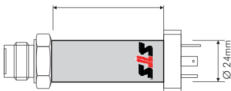
Versão para temperatura de fluidos até 125°C 25 mm para ficha DIN43650
