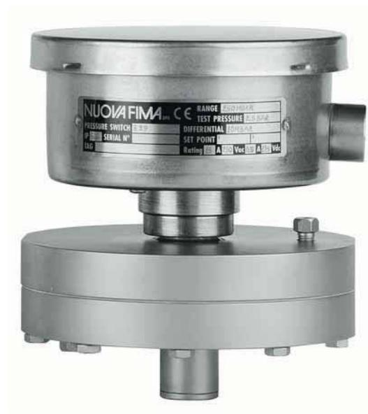
Construídos com execução estanque IP 65, são adaptados para serem utilizados nas indústrias alimentares, conservantes, farmacêuticas, petroquímica, centrais convencionais e nucleares, onde é necessário o controle de pressão diferencial e de nível. O elemento sensível é construído de uma membrana com duplo fole que por meio de um eixo soldado autocentrante que vai intervir diretamente sobre o microinterruptor.
