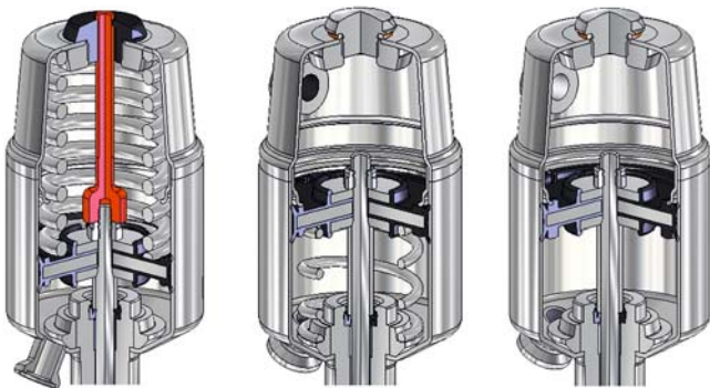
Función de mando 1 del actuador Normal cerrado (NC) Función de mando 2 del actuador Normal abierto (NO) Función de mando 3 del actuador - Doble efecto (DA)
